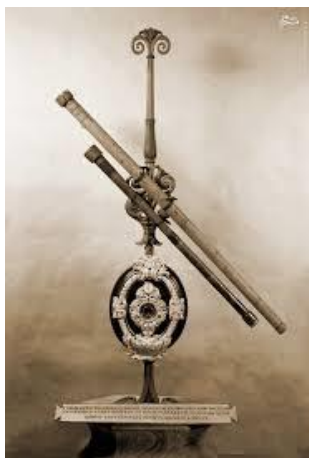
شکل (۲) تلسکوپ گالیله که ۱/۳۳ متر طول و ۲۶ میلی متر قطر داشت.
